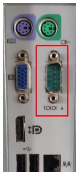
RS232 konektorea duen ekipoa, bestela RS232tik USBra adaptagailua
